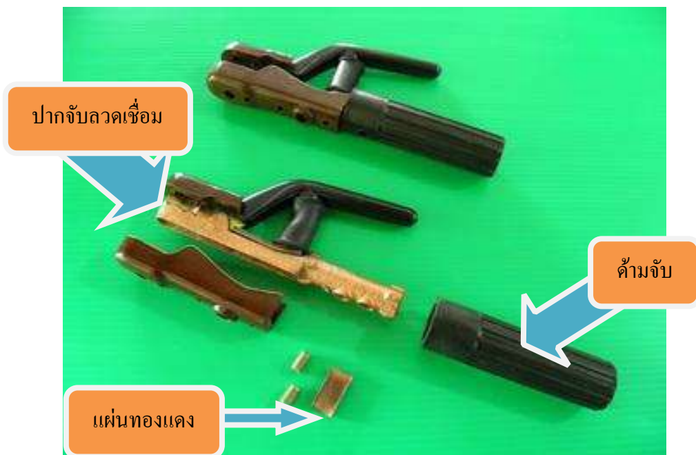
รูปที่ 1.48 แสดงลักษณะของหัวจับลวดเชื่อม
