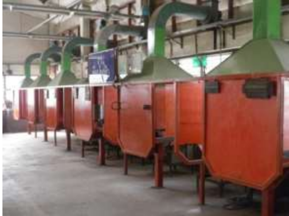
รูปที่ 1.46 แสดงลักษณะสถานีเชื่อมไฟฟ้า
