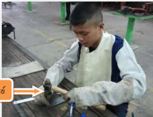
รูปที่ 1.80 แสดงเหล็กตอกนำศูนย์ตอกตามเส้นร่างแบบ
