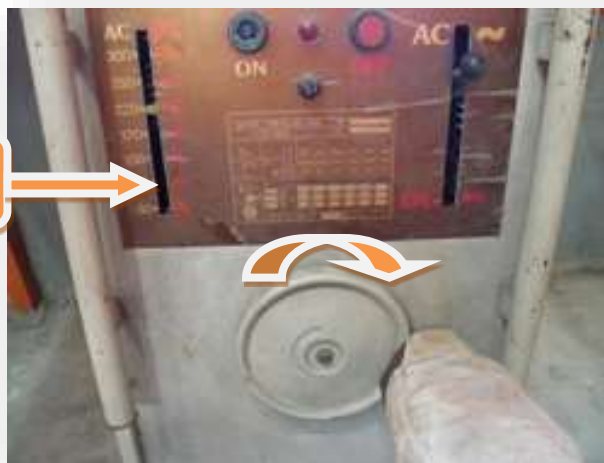
รูปที่ 1.81 แสดงการปรับกระแสเชื่อม 70 – 90 แอมป์
