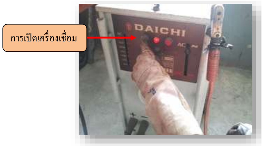
รูปที่ 1.94 แสดงเปิดเครื่องเชื่อมและปรับกระแสไฟ
