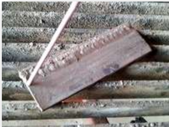
รูปที่ 1.100 แสดงลักษณะเชื่อมแนวที่ 3 ทาบแนวที่ 2
