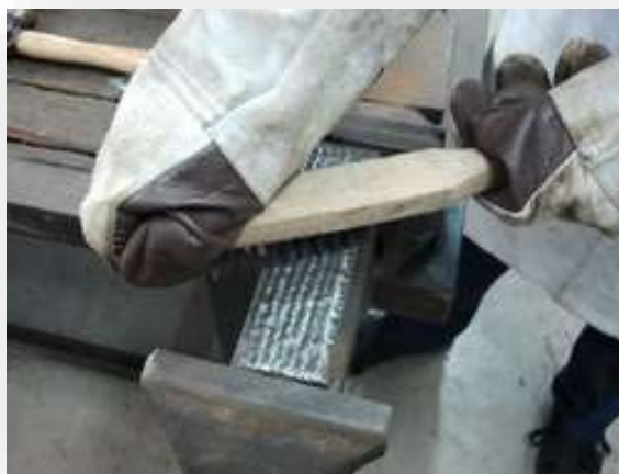
รูปที่ 1.101 แสดงลักษณะทำความสะอาดชิ้นงานโดยขัดด้วยแปรงลวด
