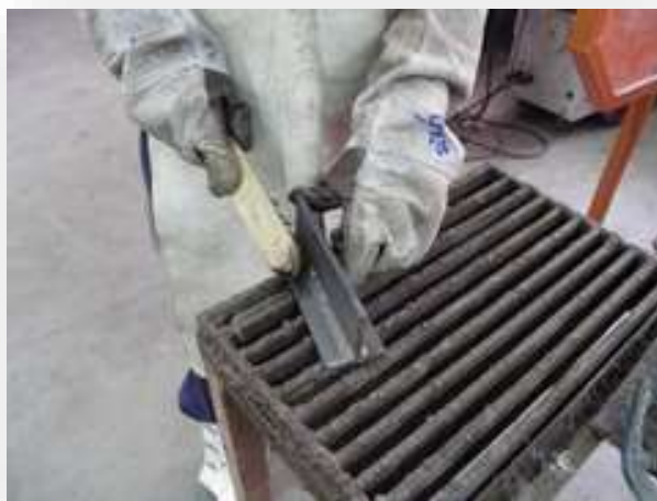
รูปที่ 1.138 แสดงการขัดด้วยแปรงลวดให้สะอาด
