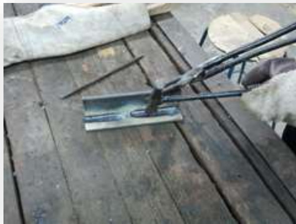
รูปที่ 1.137 แสดงการใช้ค้อนเคาะสแลกและเม็ดโลหะ
