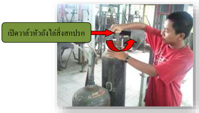
รูปที่ 2.53แสดงการเปิดวาล์วที่หัวถังแก๊สออกซิเจนให้ไหลออกมาเล็กน้อย
