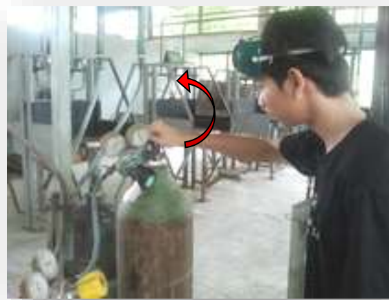
รูปที่ 2.59แสดงการเปิดวาล์วที่ถังแก๊สออกซิเจน
