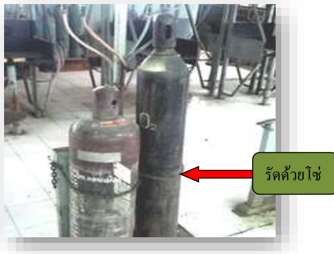
รูปที่ 2.51 แสดงการวางถังแก๊สแล้วรัดด้วยโซ่
