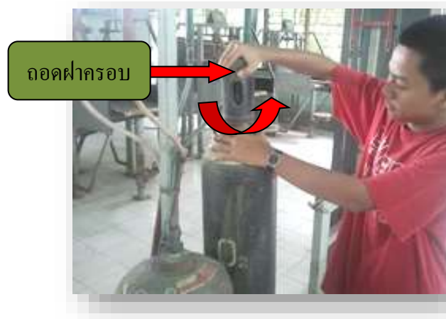
รูปที่ 2.52 แสดงการถอดฝาครอบหัวถังแก๊ส
