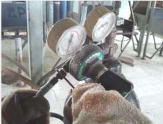
รูปที่ 2.55แสดงการต่อสายเชื่อมเข้ากับอุปกรณ์ปรับความดันแก๊สออกซิเจน
