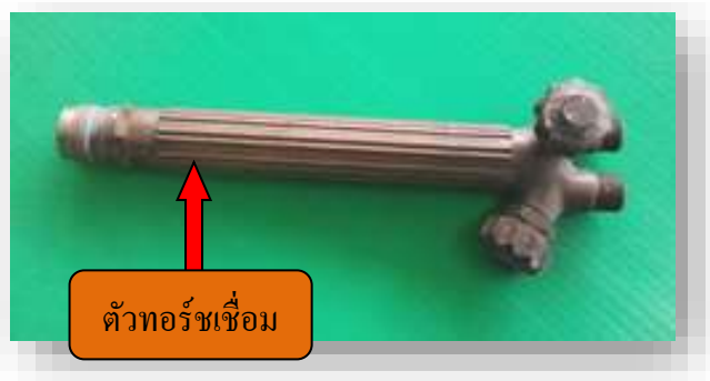
รูปที่ 2.25 แสดงลักษณะตัวทอร์ชเชื่อม
