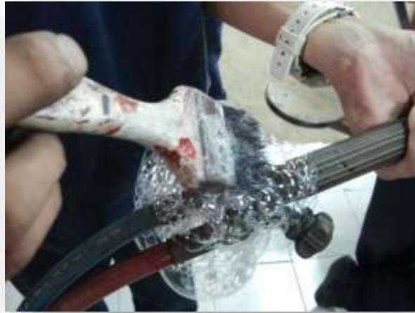
รูปที่ 2.50 แสดงการตรวจสอบรอยรั่วทุกข้อต่อด้วยน้ำสบู่
