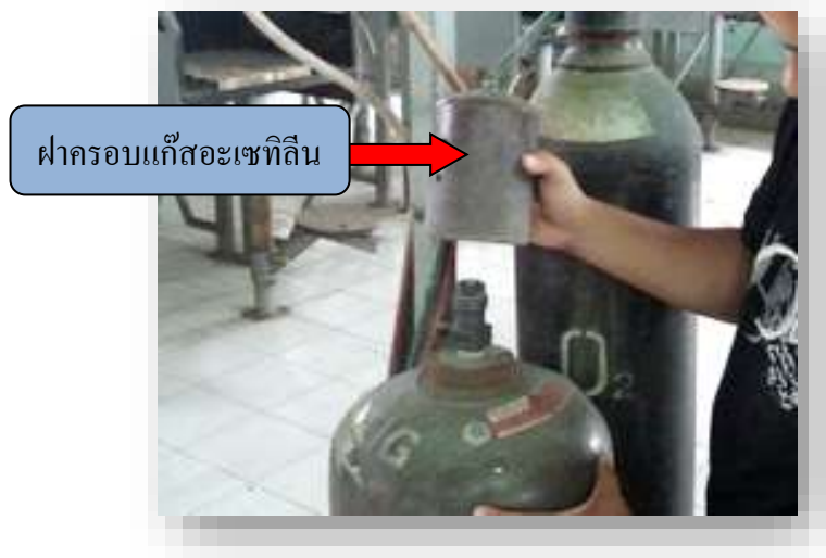
รูปที่ 2.18 แสดงลักษณะการใช้งานฝาครอบถังแก๊สอะเซทิลีน
