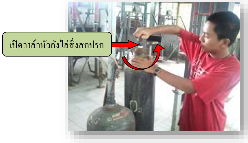
รูปที่ 2.40 แสดงการเปิดวาล์วที่หัวถังแก๊สออกซิเจนให้ไหลออกมาเล็กน้อย
