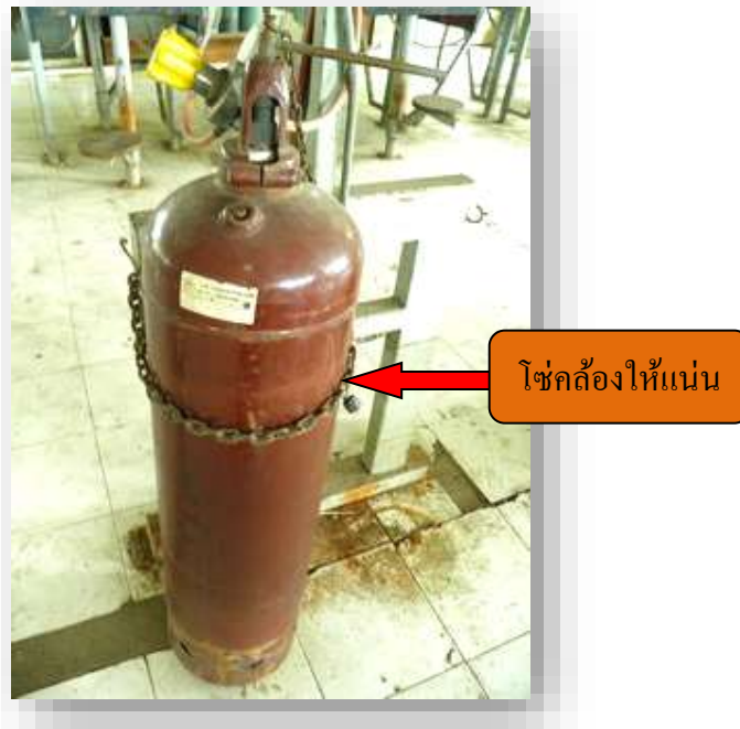
รูปที่2.13แสดงถังแก๊สควรมีโชคล็อกหรือยึดให้แน่นอยู่ตลอดเวลา
