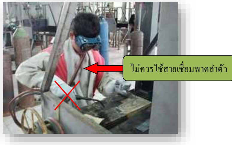
รูปที่ 2.8 แสดงการไม่ควรใช้สายเชื่อมพาดลำตัว
