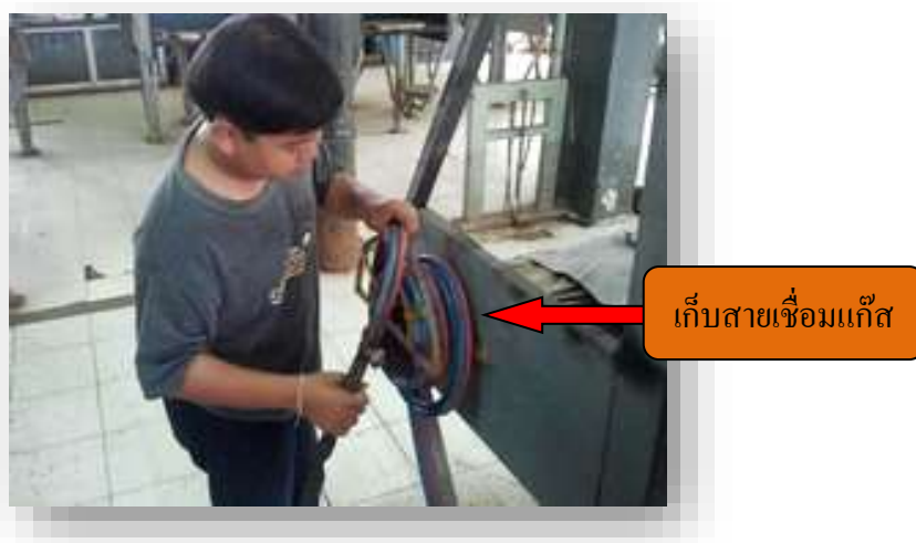
รูปที่ 2.14แสดงการเก็บสายเชื่อมแก๊สให้เรียบร้อย
