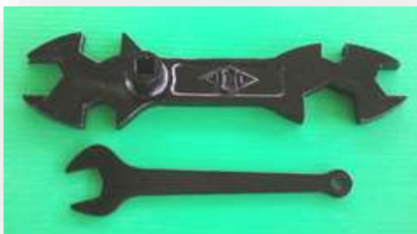
รูปที่ 2.37 แสดงลักษณะประแจเปิด-ปิดหัวถ้งแก๊สอะเซทิลีน
