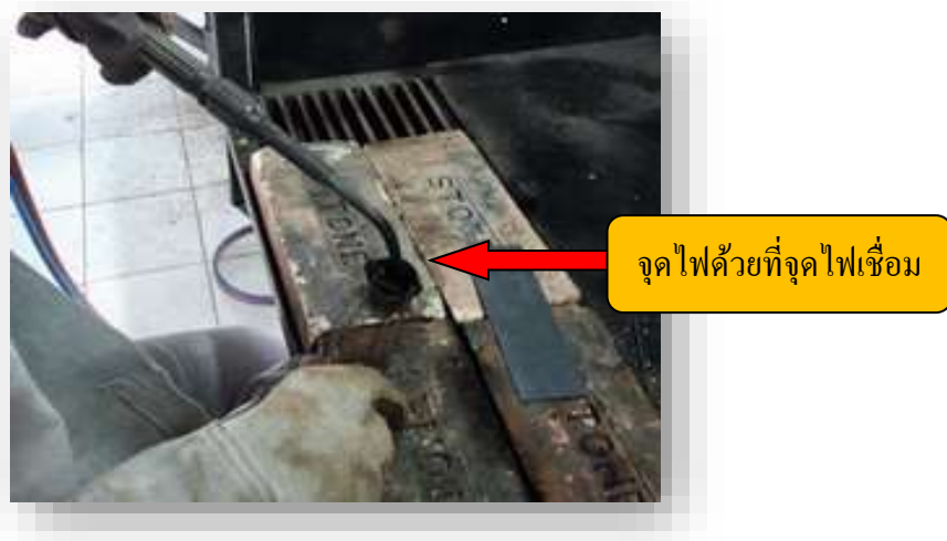
รูปที่ 2.7แสดงการจุดไฟเชื่อมด้วยที่จุดไฟ (Spark Lighter)
