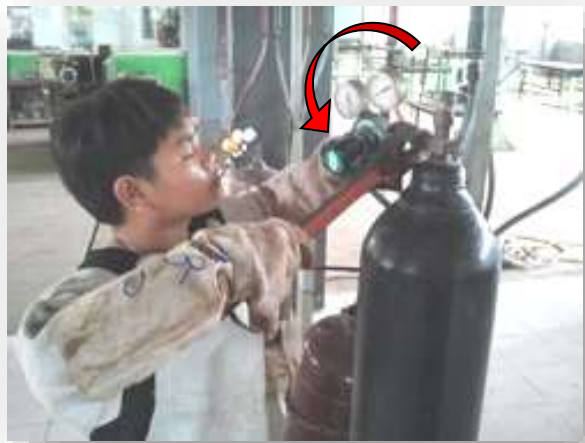
รูปที่ 2.41 แสดงการติดตั้งอุปกรณ์ปรับความดันแก๊สออกซิเจน
