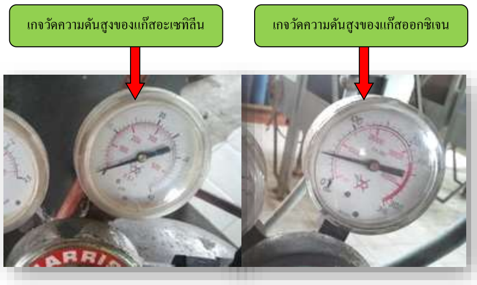
รูปที่2.21 แสดงลักษณะเกจวัดความดันสูง
