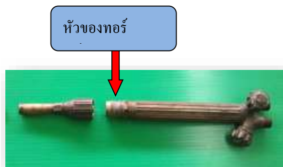
รูปที่ 2.28 แสดงลักษณะหัวของทอร์ชเชื่อมแก๊ส
