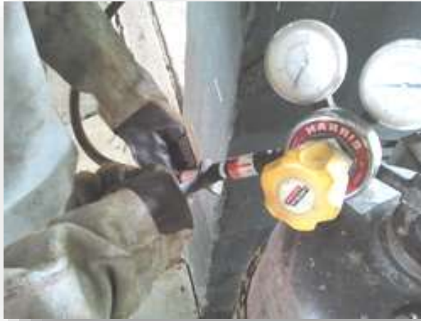
รูปที่ 2.44แสดงการต่อสายเชื่อมกับอุปกรณ์ปรับความดันแก๊สอะเซทิลีน
