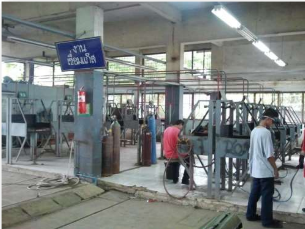
รูปที่2.1 แสดงพื้นที่ปฏิบัติงานเชื่อมจะต้องมีบรรยากาศที่เพียงพอ
