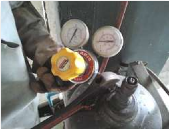
รูปที่ 2.43แสดงการติดตั้งอุปกรณ์ปรับความดันแก๊สอะเซทิลีน
