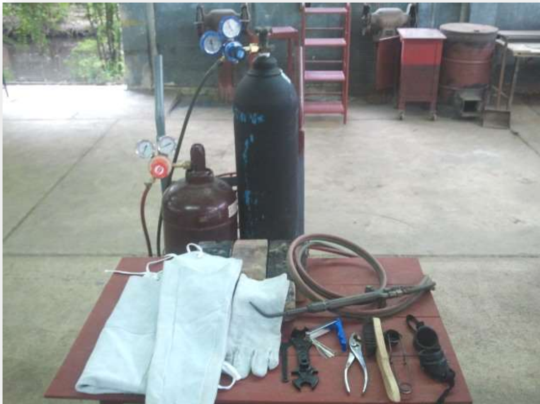
รูปที่ 2.15 อุปกรณ์เชื่อมแก๊สออกซิเจนกับอะเซทิลีน
