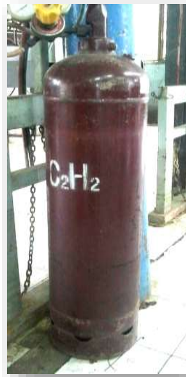
รูปที่ 2.20 แสดงลักษณะ โครงสร้างและถังบรรจุแก๊สอะเซทิลีน
