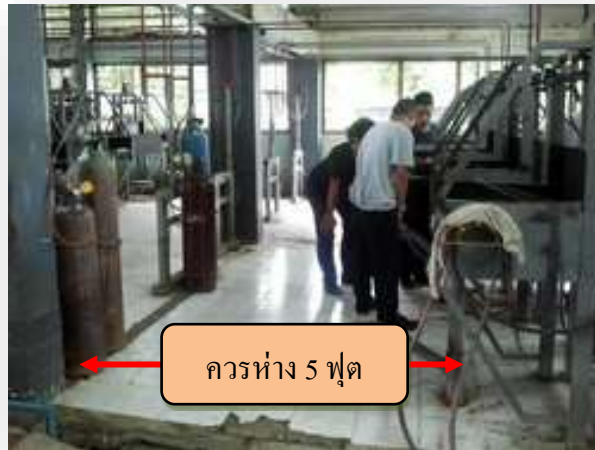
รูปที่2.2 แสดงการเชื่อมใกล้ท่อแก๊สควรถ่าง 5 ฟุต
