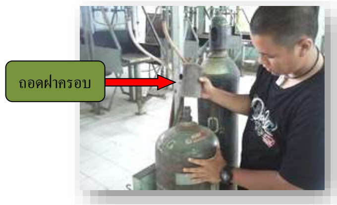
รูปที่ 2.39 แสดงการถอดฝาครอบหัวถังแก๊ส
