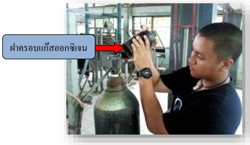
รูปที่ 2.19 แสดงลักษณะการใช้งานฝาครอบถังแก๊สออกซิเจน
