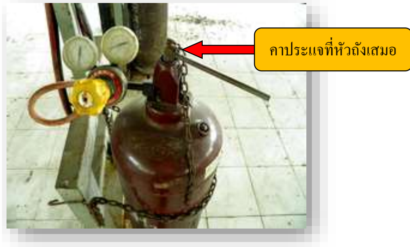
รูปที่2.6แสดงการคาประแจไว้ที่หัวถังแก๊สเสมอ
