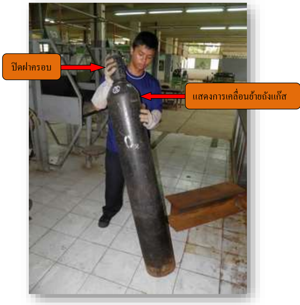
รูปที่ 2.12 ควรปิดฝาครอบเมื่อมีการเคลื่อนย้ายถังแก๊ส
