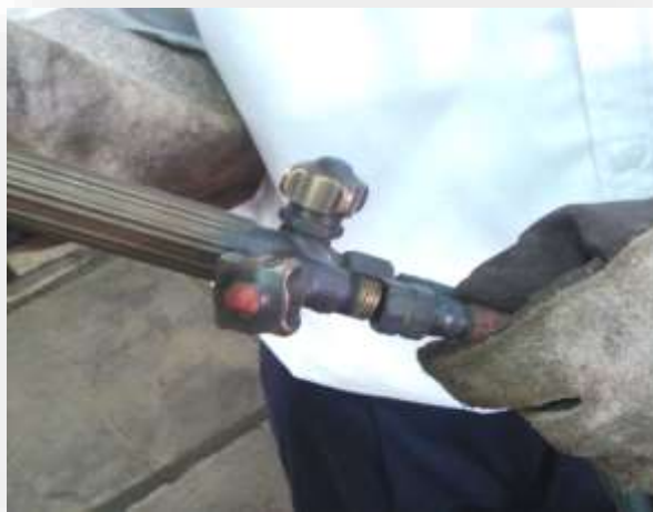
รูปที่ 2.45แสดงการประกอบสายเชื่อมเข้ากับหัวเชื่อม
