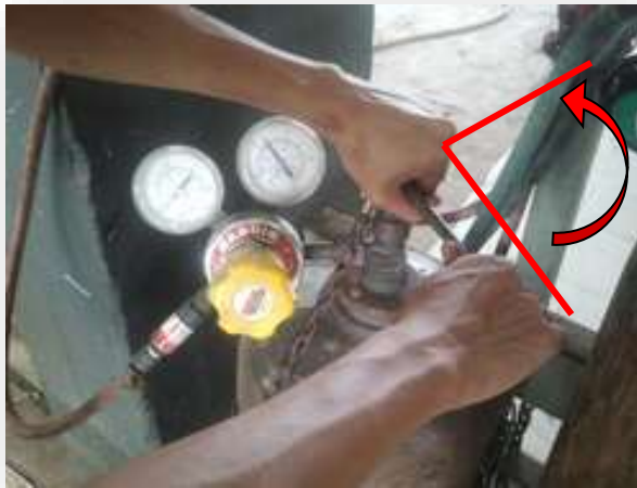
รูปที่ 2.47 แสดงการเปิดวาล์วที่ถังแก๊สอะเซทิลีน
