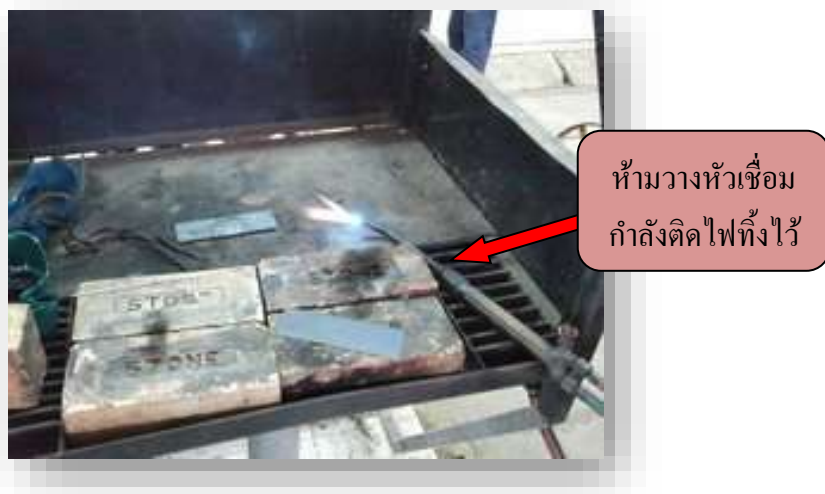
รูปที่ 2.11แสดงการห้ามวางหัวเชื่อมแก๊สที่กำลังติดไฟทิ้งไว้
