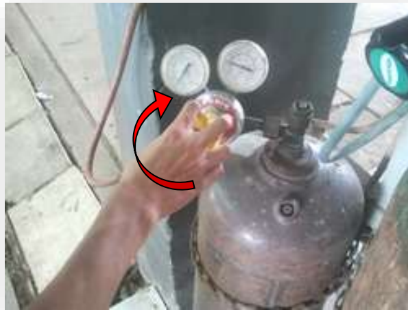
รูปที่ 2.48แสดงการหมุนปรับความดันแก๊สอะเซทิลีน
