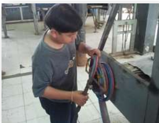
รูปที่ 2.80 แสดงการเก็บม้วนสายยางเชื่อมแก๊สไว้ที่แขวน
