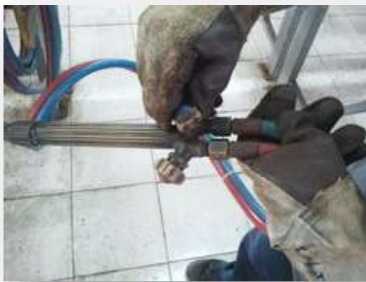
รูปที่ 2.79 แสดงการเปิดวาล์วที่หัวเชื่อมแก๊ส
