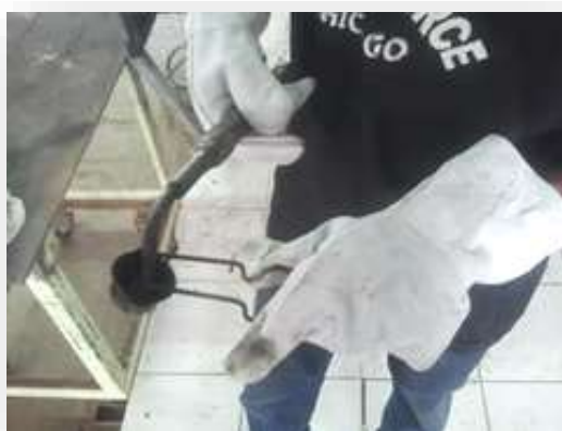
รูปที่ 2.72 แสดงการจุดด้วยที่จุดเปลวไฟ
