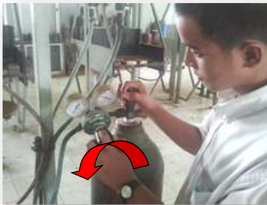
รูปที่ 2.78 แสดงการคลายสกรูปรับความดันแก๊ส
