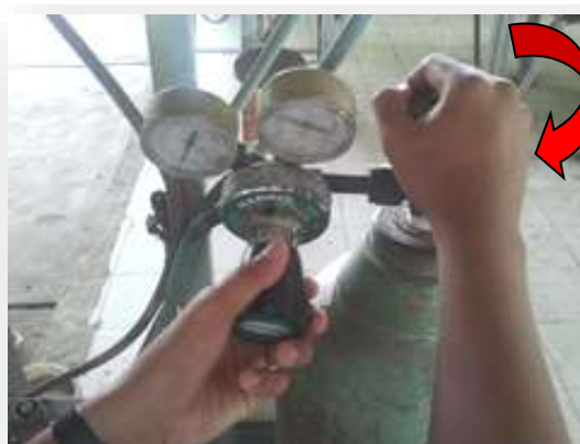
รูปที่ 2.77 แสดงการปิดวาล์วแก๊สออกซิเจน
