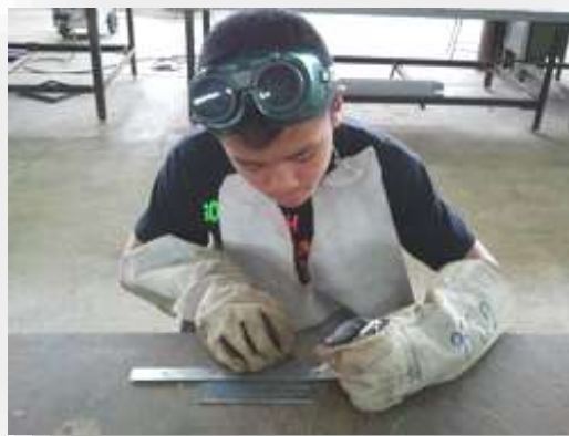
รูปที่ 2.95 แสดงการร่องแบบด้วยเหล็กขีด
