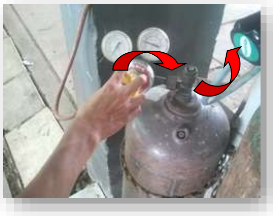
รูปที่ 2.97 แสดงการปรับความดันแก๊สอะเซทิลีน
