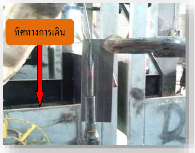
รูปที่ 2.88 แสดงลักษณะท่าเชื่อมทำตั้งเชื่อมลง
