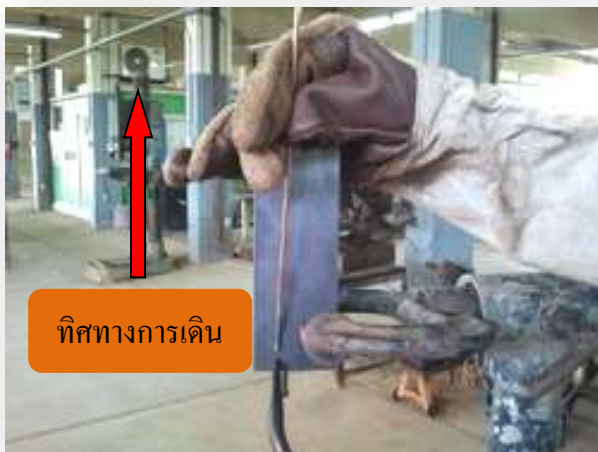
รูปที่ 2.87 แสดงลักษณะท่าเชื่อมท่าตั้งเชื่อมขึ้น
