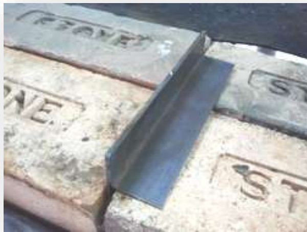
รูปที่ 2.92 แสดงลักษณะรอยต่อขอบ
