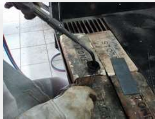
รูปที่ 2.125 ลักษณะการจุดเปลวไฟ
