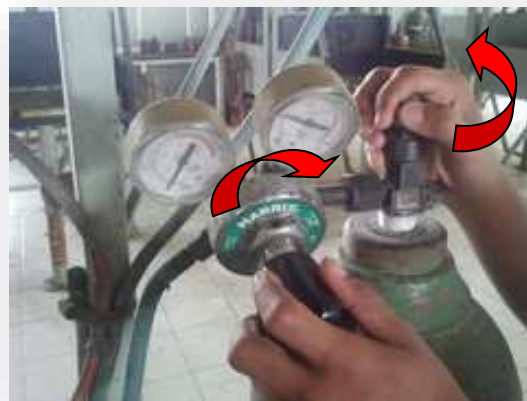
รูปที่ 2.124 ลักษณะการปรับความดันแก๊สออกซิเจน
