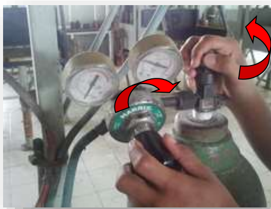
รูปที่ 2.161 ลักษณะการปรับความดันแก๊สออกซิเจน
