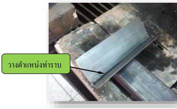
รูปที่ 2.165 แสดงลักษณะวางชิ้นงานในตำแหน่งทำราบ
