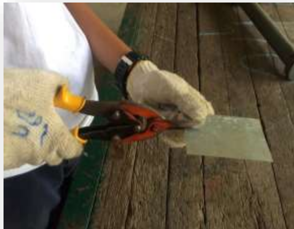
รูปที่ 3.17 แสดงการตัดด้วยกรรไกรตัดตรง
