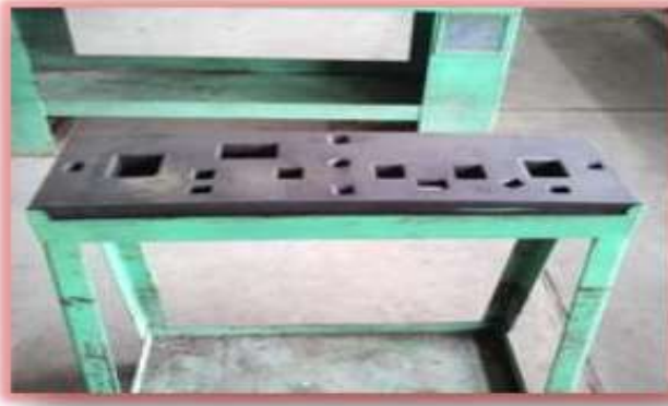
รูปที่ 3.44 โต๊ะรองแท่นขึ้นรูป Stand No.985
