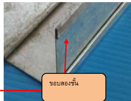
รูปที่ 3.68 แสดงลักษณะการพับขอบสองชั้น
