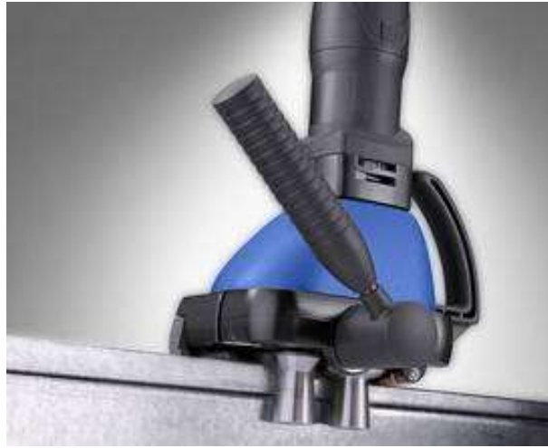
รูปที่ 3.84 แสดงลักษณะการพับขึ้นรูปด้วยเครื่องตะเข็บพิตส์เบิร์ก (Pittsburgh Lock)
