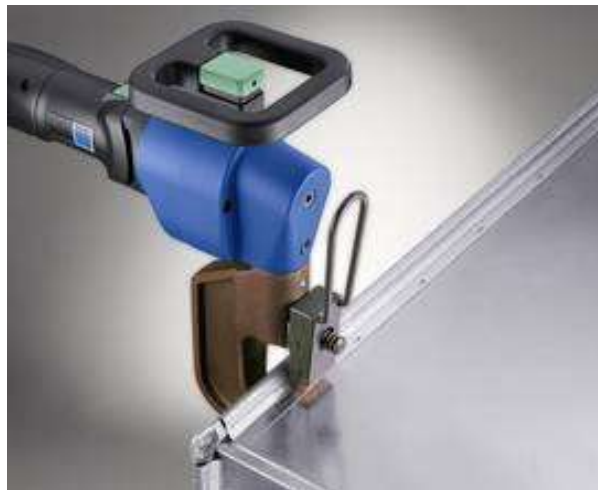
รูปที่ 3.83 แสดงลักษณะการพับขึ้นรูปด้วยเครื่องตะเข็บพิตส์เบิร์ก (Pittsburgh Lock)
