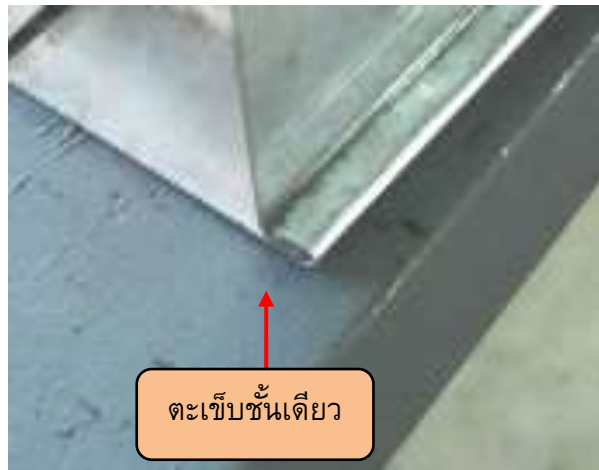
รูปที่ 3.76 แสดงลักษณะตะเข็บชั้นเดียว
