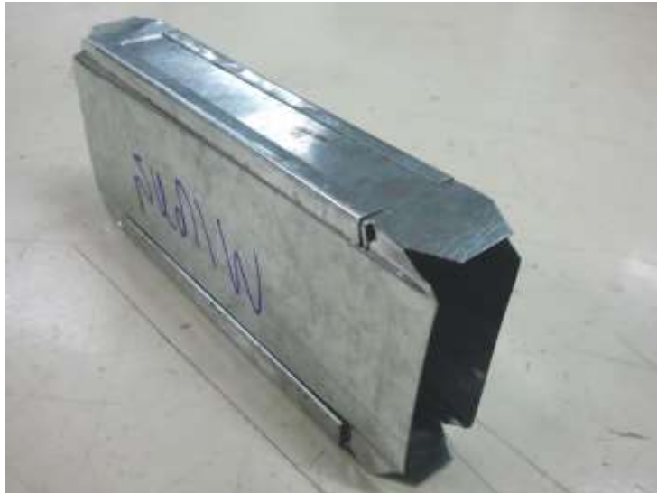
รูปที่ 3.82 แสดงลักษณะชิ้นงานพับขึ้นรูปด้วยตะเข็บพิตส์เบิร์ก (Pittsburgh Lock)
