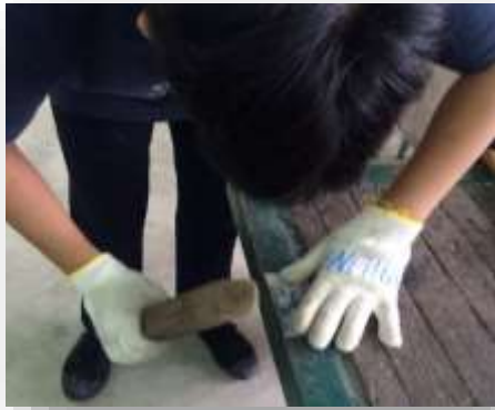
รูปที่ 3.125 การตีพับขอบชิ้นเดียวในส่วนที่ 1
