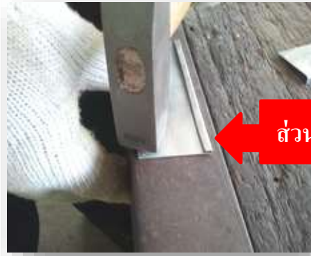
รูปที่ 3.125 การตีพับขอบชิ้นเดียวในส่วนที่ 1
