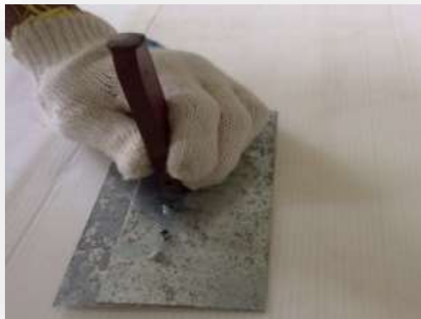
รูปที่ 3.154 แสดงการตอกชิ้นงานติดกันแนบสนิทพอดีกับหัวหมุด
