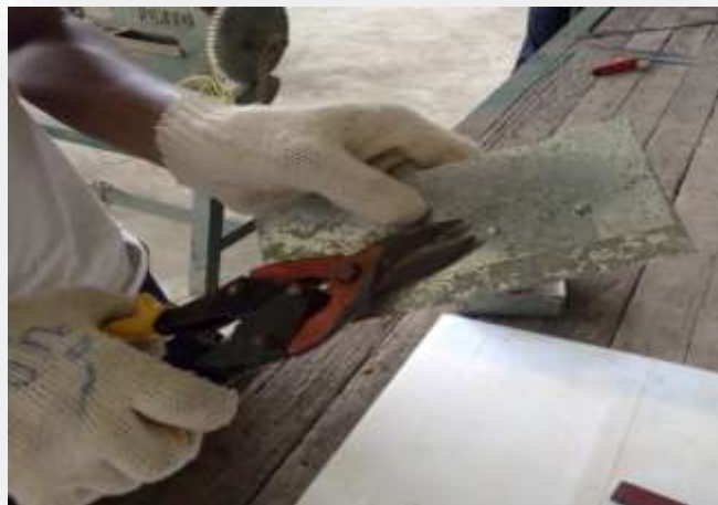
รูปที่ 3.155 แสดงการตัดหมุดย้ำเมื่อหมุดย้ำยาวเกินไป
