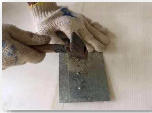
รูปที่ 3.156 แสดงขั้นตอนการเคาะหัวหมุด
