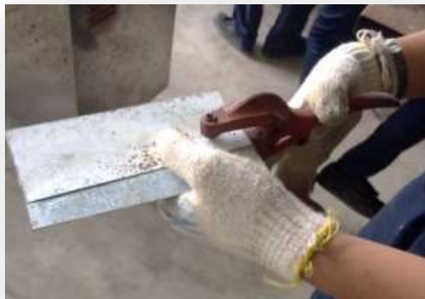
รูปที่ 3.151 แสดงการเจาะรูด้วยเครื่องเจาะรูด้วยมือ
