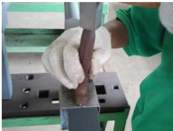
รูปที่ 3.166 แสดงการย้ำตะเข็บด้วยเหล็กย้ำตะเข็บ
