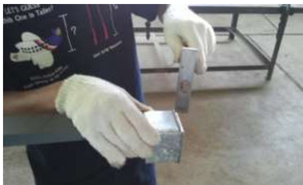
รูปที่ 3.171 แสดงการใช้ค้อนเคาะตีฐานกล่องสี่เหลี่ยมโดยตีพับตะเข็บสองชั้นทั้ง 4 ด้าน
