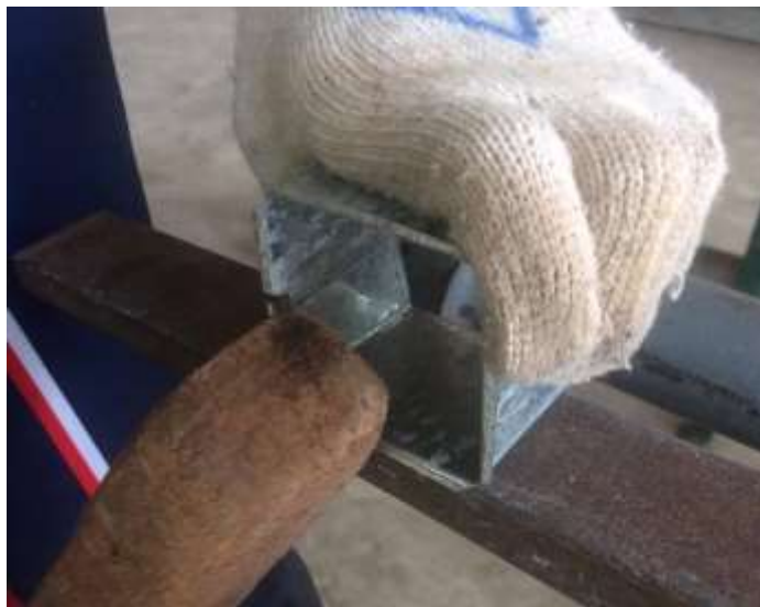
รูปที่ 3.167 แสดงการใช้ค้อนตีพื้นฐานของตัวกล่องสี่เหลี่ยมให้ตั้งฉาก
