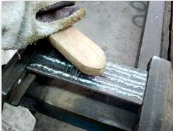
รูปที่ 1.86 แสดงการขัดชิ้นงานด้วยแปรงลวด
