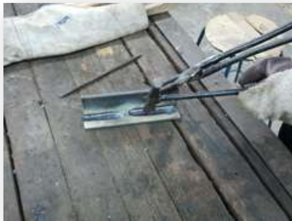
รูปที่ 1.137 แสดงการใช้ก้อนเคาะสแลกและเม็ดโลหะ
