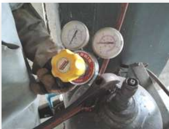
รูปที่ 2.56 แสดงการติดตั้งอุปกรณ์ปรับความดันแก๊สอะเซทิลีน
