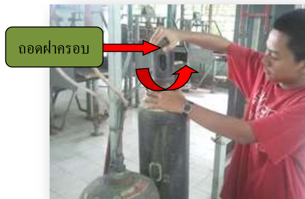
รูปที่ 2.52 แสดงการถอดฝาครอบหัวถังแก๊ส
