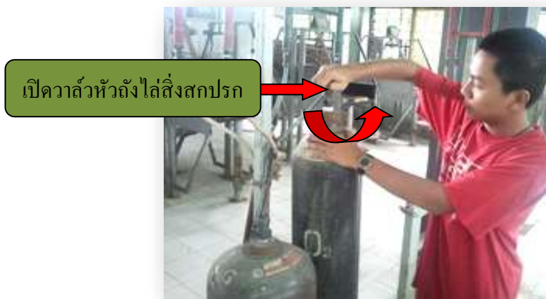
รูปที่ 2.53แสดงการเปิดวาล์วที่หัวถังแก๊สออกซิเจนให้ไหลออกมาเล็กน้อย
