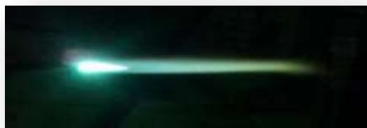
รูปที่ 2.73 แสดงการปรับเปลวคาร์บูไรซิงเฟรมหรือเปลวลด
