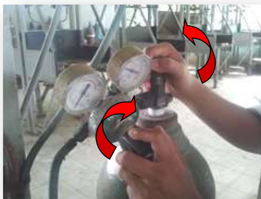
รูปที่ 2.98 แสดงการปรับความดันแก๊สออกซิเจน
