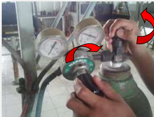
รูปที่ 2.161 ลักษณะการปรับความดันแก๊สออกซิเจน
