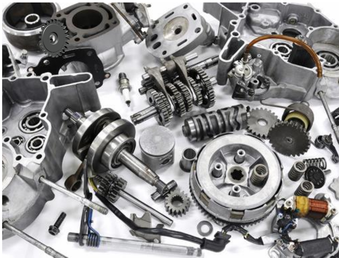
ภาพที่ 2.9 ชิ้นส่วนของรถยนต์ที่ผลิตจากเหล็กกล้าและเหล็กหล่อ ที่มา http://www.thaiauto.or.th/2012/th/news/news-detail.asp?news_id=3255
