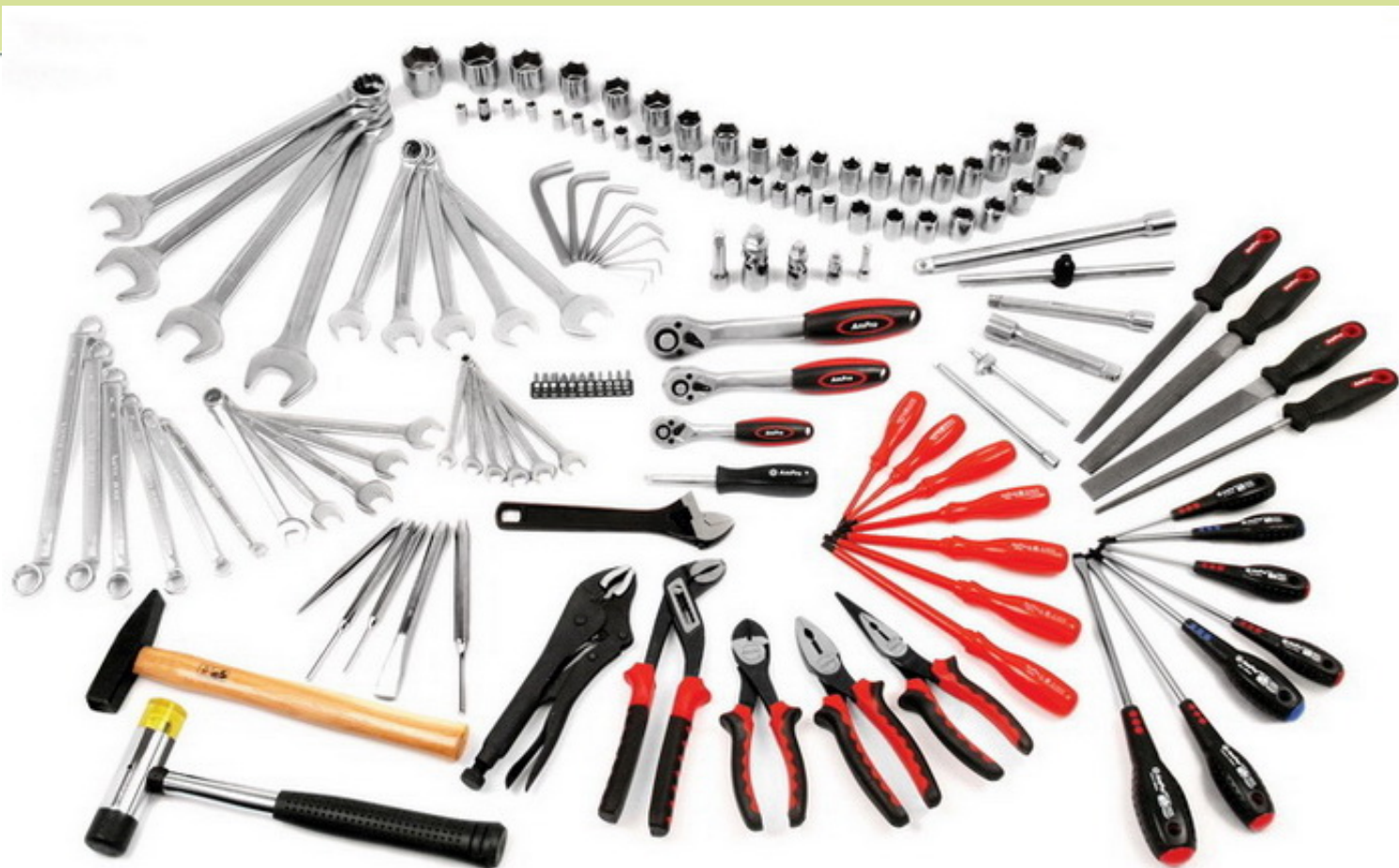
ภาพที่ 2.10 เครื่องมือช่างที่ผลิตจากเหล็กกล้าคาร์บอน ที่มา http://thaihandtool.com/forum/5/6
