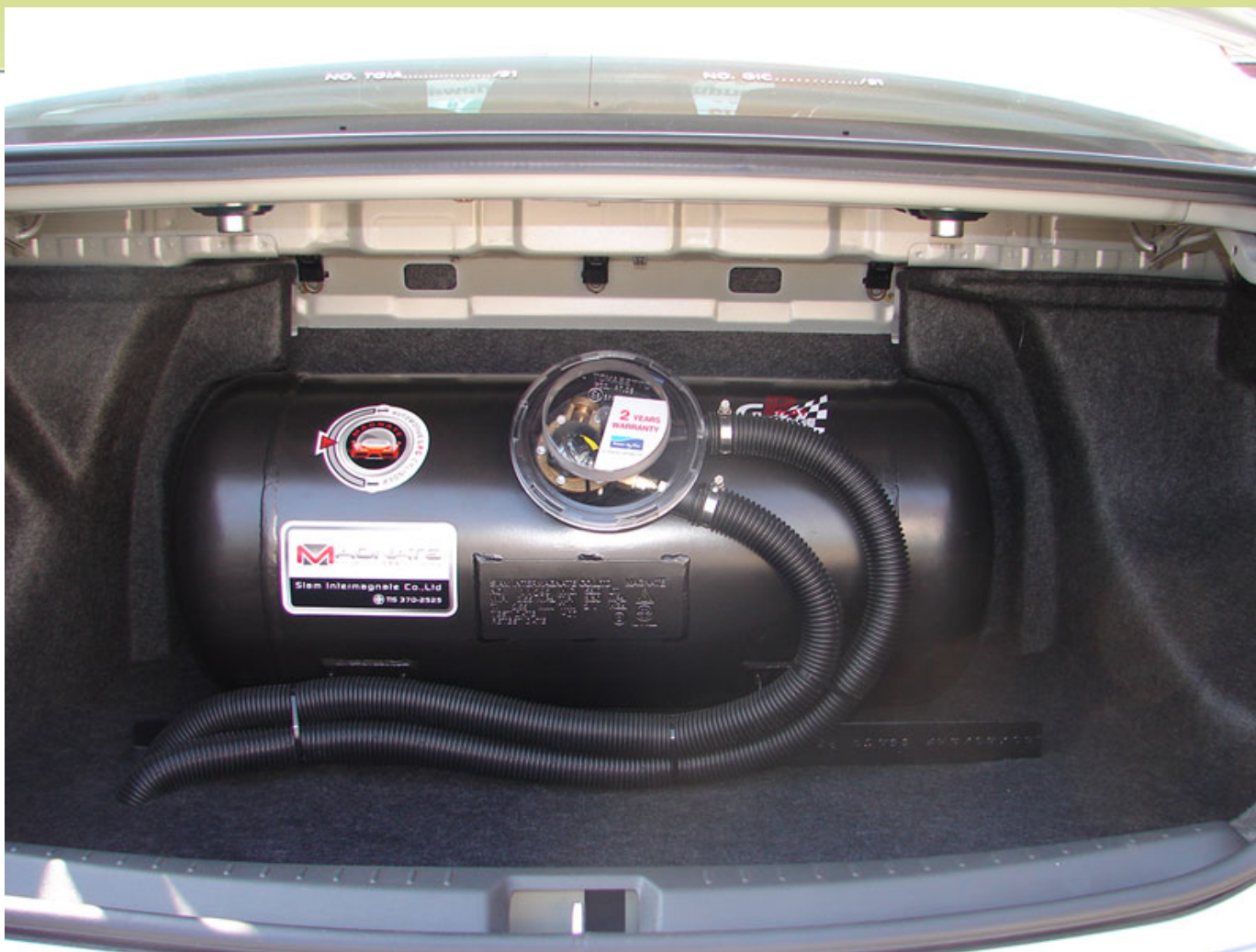
ภาพที่ 7.16 ตำแหน่งติดตั้งถังแก๊สในรถยนต์ ที่มา http://infothailandseo1.weebly.com/blog/1
