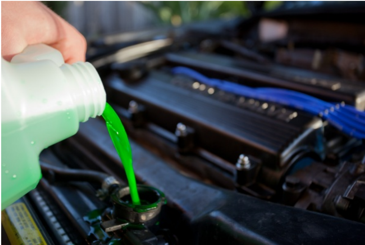
ภาพที่ 12.3 การใช้ยาหล่อเย็นป้องกันตะกอนและการกัดกร่อน ที่มา http://car.boxzaracing.com/knowledge/10800
