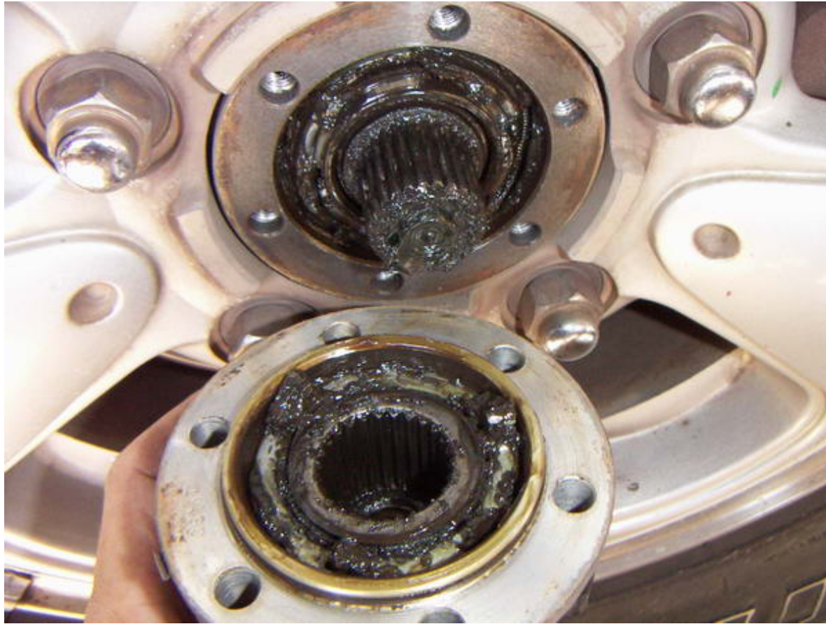
ภาพที่ 12.4 การใช้จารบีเพื่อป้องกันการสึกหรอจากการหมุนของตูกปืน ที่มา http://www.auto2drive.com
