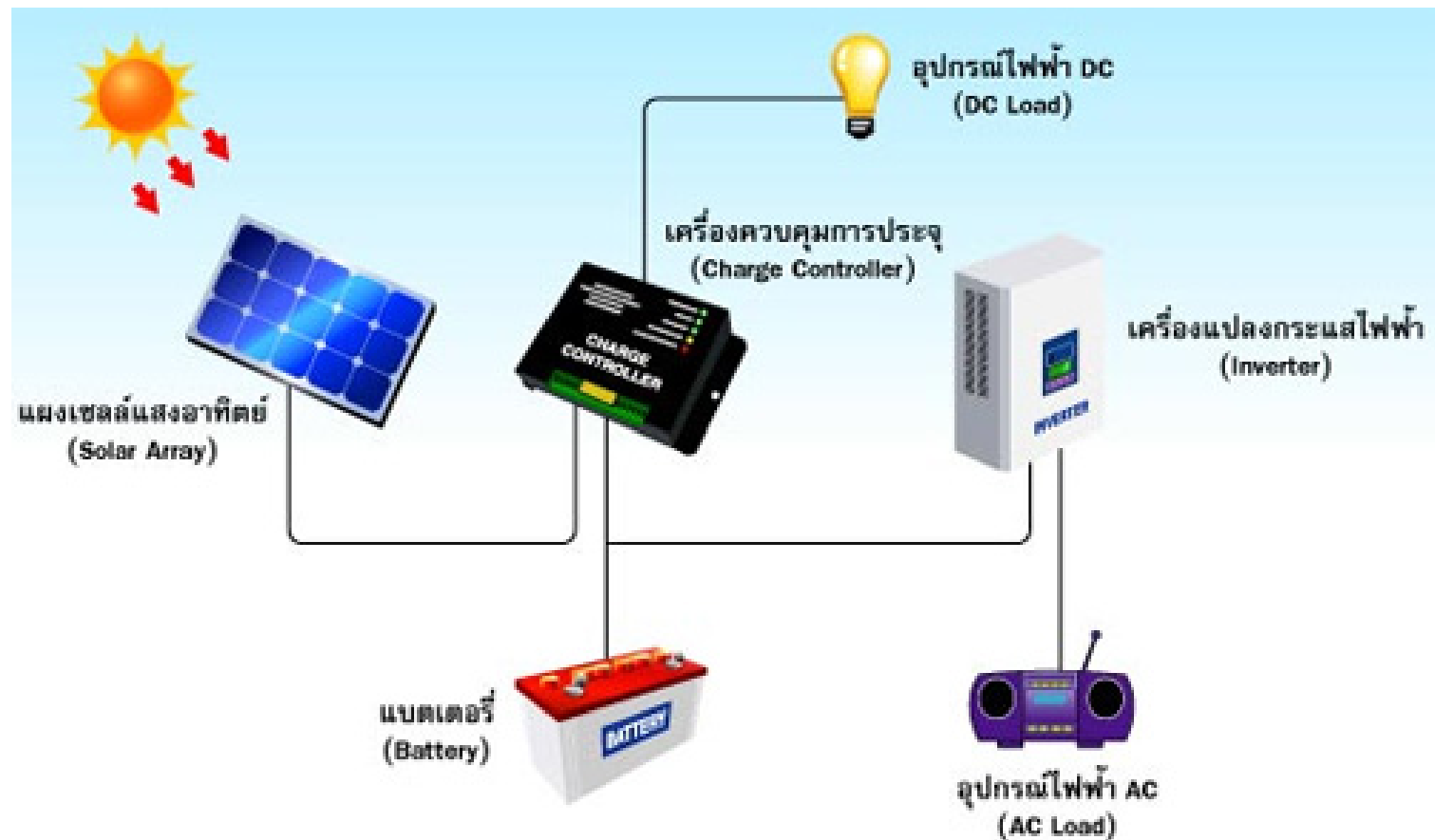
ภาพที่ 14.3 ระบบผลิตไฟฟ้าจากเซลล์แสงอาทิตย์
