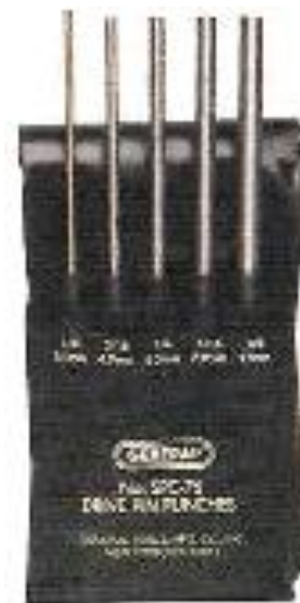
รูปที่ 2-22 เหล็กส่งลำตัวทรงกระบอกตรง และมีปลายตัดตรง
