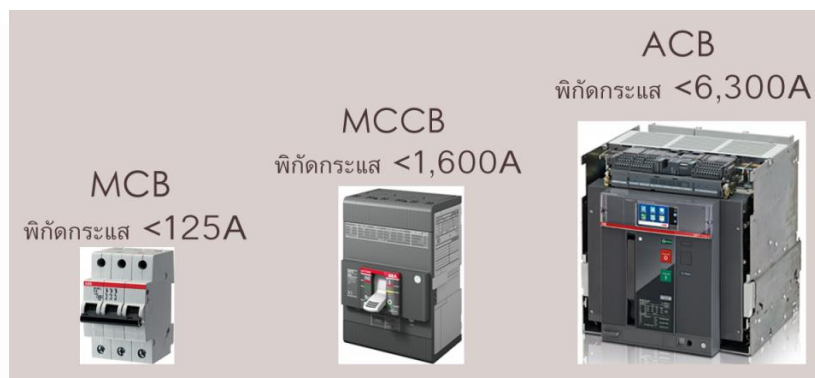
รูปที่ 7.7 แสดงการแบ่งขนาดของเซอร์กิตเบรกเกอร์
