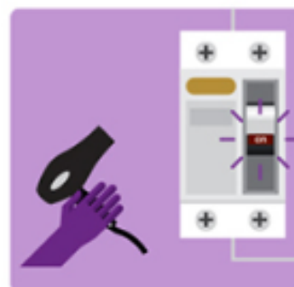
(ข) เครื่องตัดกระแสไฟฟ้าอัตโนมัติ
