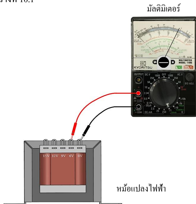
รูปที่ 10.3 การวัดความต้านทานหม้อแปลงไฟฟ้าขดทุติยภูมิ
