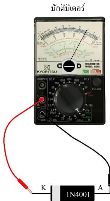
รูปที่ 11.1 การวัดและทดสอบไดโอดด้วยมัลติมิเตอร์
