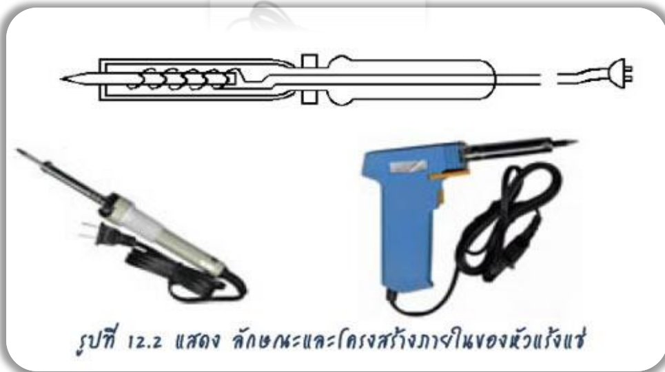
ภาพ 15.5 แสดง ลักษณะและโครงสร้างภายในของหัวแร้งแช่
