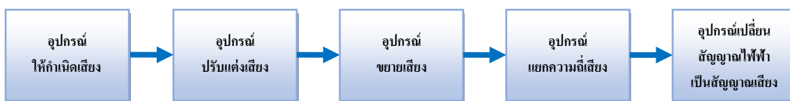
ภาพที่ 2.3 บล็อกไดอะแกรมเครื่องเสียงระบบไฮไฟ
