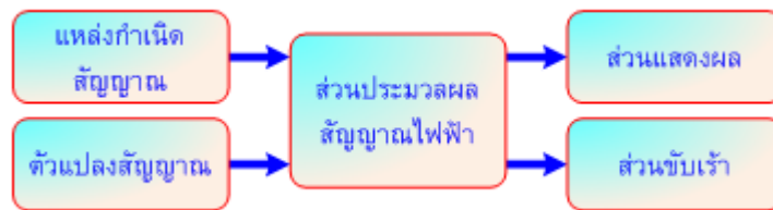
รูปที่ 4.1 ส่วนประกอบของการขยายสัญญาณไฟฟ้า
