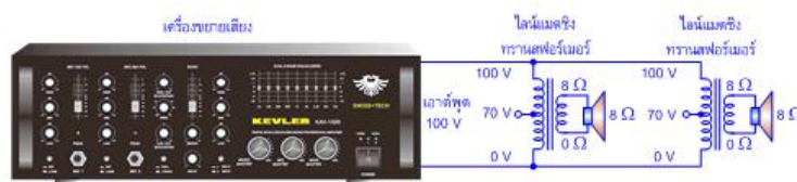
รูปที่ 12.15 การต่อไลน์แมตชิงทรานสฟอร์มเมอร์ชนิดแรงดันไฟฟ้าคงที่หลายตัวเข้ากับเครื่องขยายเสียง
