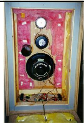
รูปที่ 12.2 ประกอบวงจรแยกเสียงท่อมแหลมเข้าสู่ลำโพง
