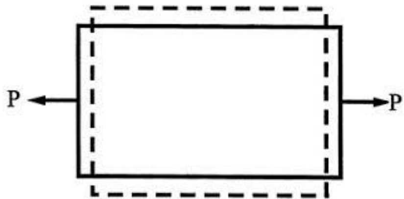
a) แรงดึง (Tension)
