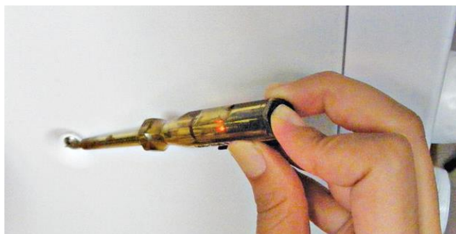
รูปที่ 1.5 แสดงการใช้ไขควงลองไฟตรวจสอบวัสดุที่เป็นโลหะของเครื่องใช้ไฟฟ้า
