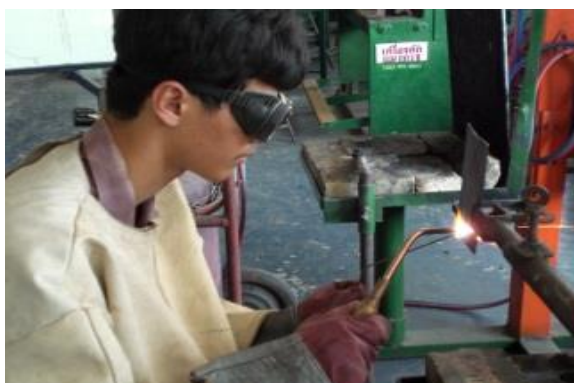
รูปที่ 4.11 ใส่ชุดป้องกันอันตรายทุกครั้งที่ทำกรเชื่อมและติดตั้งอุปกรณ์อย่างถูกวิธี ที่มา : ชลอ ประยูรพันธ์ : 2557
