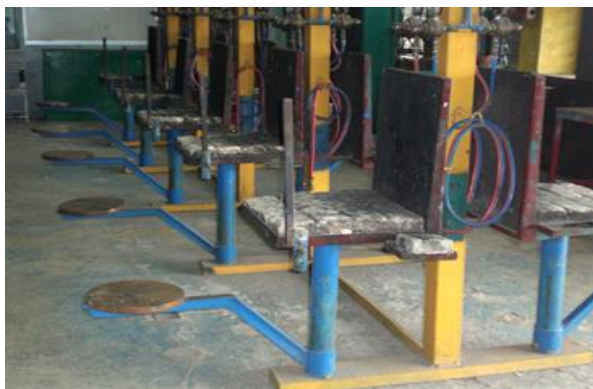
รูปที่ 4.1 แสดงบริเวณพื้นที่ปฏิบัติงานเชื่อมแก๊สที่มีแสงสว่างเพียงพอ
