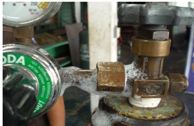
รูปที่ 4.10 แสดงการใช้น้ำฟองสบู่หรือน้ำผงซักฟอกในการตรวจสอบรอยรั่วของแก๊สเชื่อม
