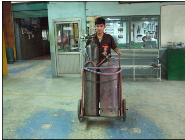
รูปที่ 4.15 แสดงการปฏิบัติงานเคลื่อนย้ายท่อแก๊สโดยการใช้รถเข็นแบบท่อคู่ ที่มา : ชลอ ประยูรพันธ์ : 2557
