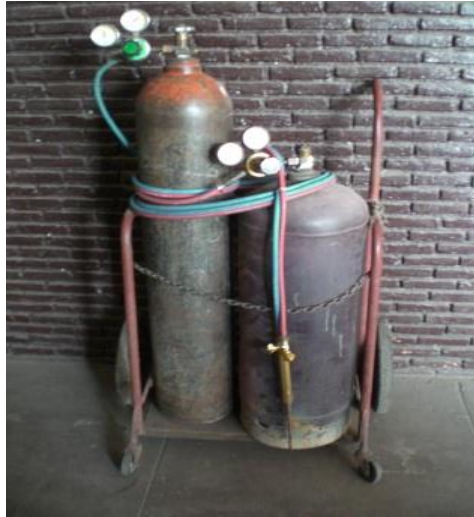
รูปที่ 4.9 แสดงการเคลื่อนย้ายท่อแก๊สโดยใช้รถเข็น
