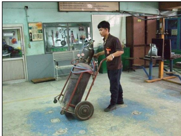
รูปที่ 4.16 แสดงการปฏิบัติงานเคลื่อนย้ายท่อแก๊สโดยการใช้รถเข็นแบบท่อคู่ ที่มา : ชลอ ประยูรพันธ์ : 2557
