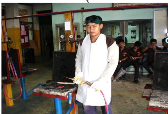
รูปที่ 4.11 ใส่ชุดป้องกันอันตรายทุกครั้งที่ทำกรเชื่อมและติดตั้งอุปกรณ์อย่างถูกวิธี ที่มา : ชลอ ประยูรพันธ์ : 2557
