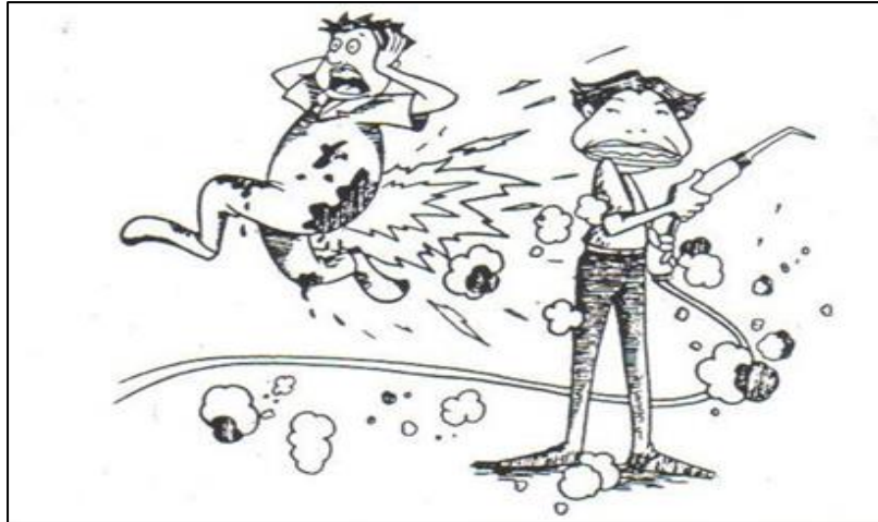
รูปที่ 1.12 ภาพชุดปฏิบัติงานที่เปื้อนน้ำมันมีโอกาสติดไฟได้มาก
