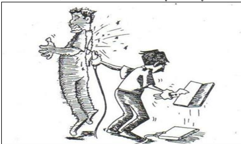
รูปที่ 1.34 การถือหัวเชื่อมต้องระวังไม่ให้ถูกผู้อยู่ข้างเคียง
