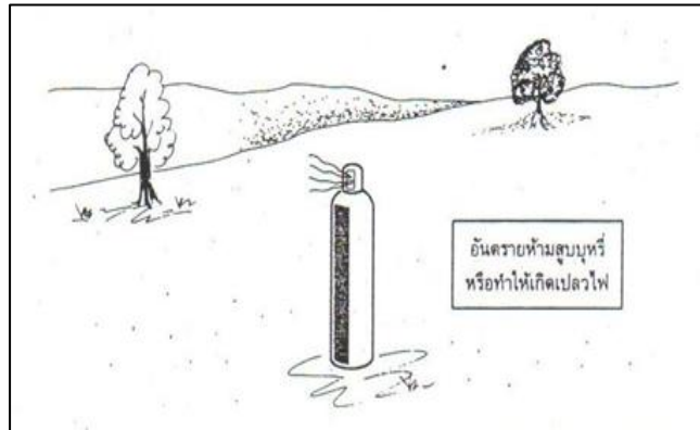
รูปที่ 1.6 กรณีแก๊สรั่วให้นำออกกลางแจ้งแล้วปล่อยทิ้งไว้ (ที่มา หนังสือ งานเชื่อมและโลหะแผ่นเบื้องต้น นริศ ศรีเมฆ และ คณะ)รูปที่ 1.4 หน้า 8
