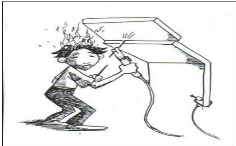
รูปที่ 1.33 การเชื่อมควรสวมหมวก เมื่อเชื่อมชิ้นงานทำเหนื่อศิระษะ
