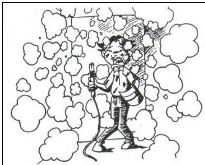
รูปที่ 1.30 การเชื่อมในห้องที่ปิด ควันจะเป็นอันตรายต่อผู้เชื่อม
