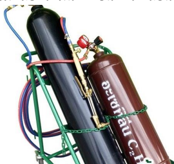
รูปที่ 1.1 แสดงการผูกมัดท่อแก๊สออกซิเจนและท่อแก๊สอะเซทิลีนติดกับรถเข็นให้มั่นคง (ที่มา https://th.images.search.yahoo.com )
