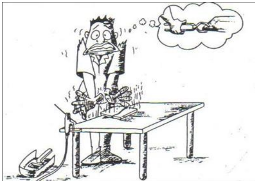
รูปที่ 1.32 การเชื่อมควรใช้คีมจับชิ้นงานที่ร้อน
