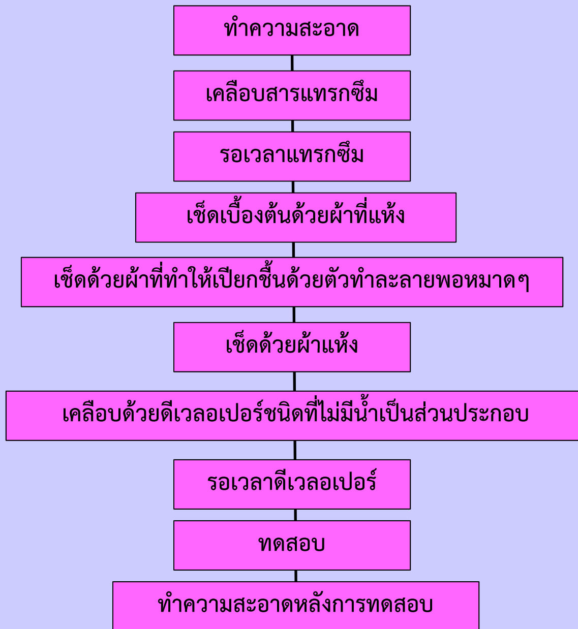
รูปที่ 4 สารแทรกซึมชนิดกำจัดออกด้วยตัวทำละลาย
