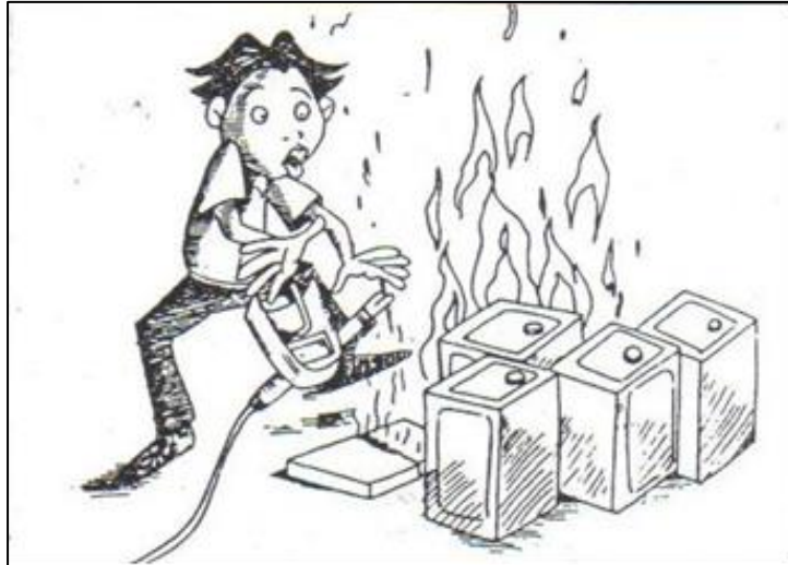
รูปที่ 1.29 อย่าเชื่อมใกล้ถังน้ำมันเชื้อเพลิง
