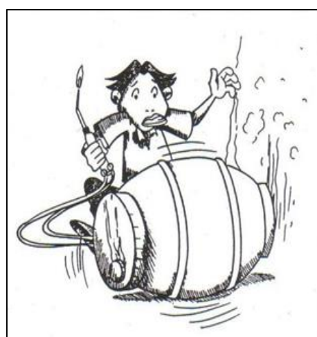
รูปที่ 1.22 อย่าเชื่อมภาชนะโลหะปิดฝาอยู่
