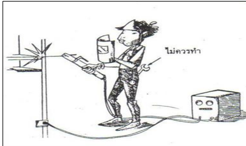
รูปที่ 1.36 การสวมใส่เครื่องประดับ และพกเครื่องมือไว้ตามส่วนต่างๆของร่างกาย เป็นการแต่งกายไม่ถูกต้อง
