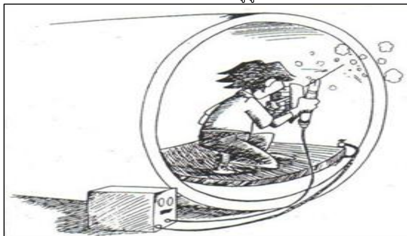
รูปที่ 1.37 การใช้ฉนวนรองนั่งทำงานเมื่อทำการเชื่อมในถังเหล็ก
