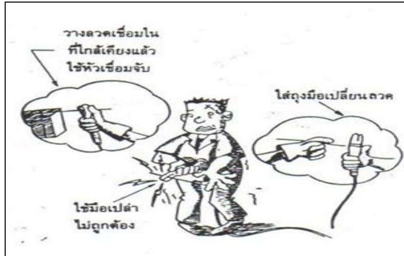
รูปที่ 1.38 การเปลี่ยนลวดเชื่อมที่ถูกต้อง
