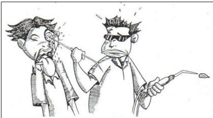
รูปที่ 1.20 หลังการเชื่อมเสร็จแล้วเปลวไฟและลวดเชื่อมต้องเคลื่อนหรือเปลี่ยนตำแหน่งด้วยความระมัดระวัง
