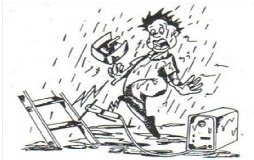
รูปที่ 1.28 การเกิดอันตรายได้เมื่อทำการเชื่อมบนพื้นที่เปียก (ที่มา หนังสือ งานเชื่อมและโลหะแผ่นเบื้องต้น นริศ ศรีเมฆ และ คณะ)รูปที่ 1.6 หน้า 6)
