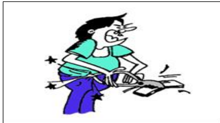
รูปที่ 1.43 การตัดงานหนามากเกินไปมีโอกาสเกิดอันตรายได้มากกว่าการตัดงานบาง
