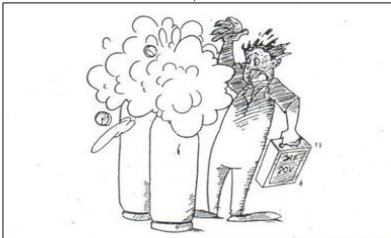
รูปที่ 1.15 ท่อแก๊สอาจทำปฏิกิริยากับน้ำมันหรือจาระบีเกิดการระเบิดได้
