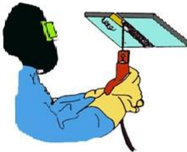
รูปที่ 2.4 ทำเชื่อมทำเหนือศีรษะ
