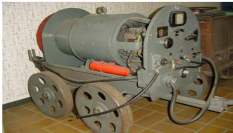
รูปที่ 3.6 เครื่องเชื่อมกระแสตรงแบบมอเตอร์เจเนเรเตอร์
