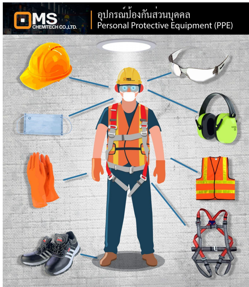
รูปแสดง การแต่งกายอุปกรณ์ป้องกันส่วนบุคคล( Personal Protective Equipment , PPE )
