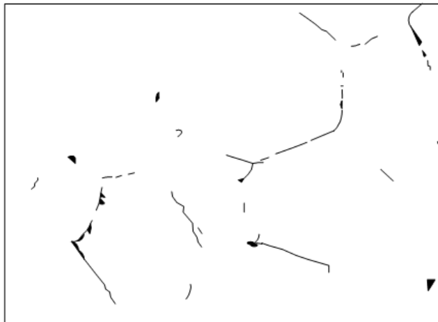
รูปที่ 4 โครงสร้างจุลภาคแสดงปริมาณเฟอร์ไรท์ที่ขอบเกรนสำหรับรางทุกเกรต ยกเว้นเกรต 200 และ 220 (ที่มา: คู่มือการออกแบบและก่อสร้างโครงสร้างทางรถไฟ สนข.)
