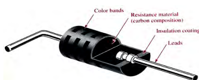
รูปที่ 1.76 ตัวต้านทานแบบคาร์บอน
