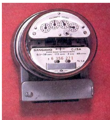
รูปที่ 1.73 เครื่องมือวัดกิโลวัตต์-ชั่วโมงมิเตอร์
