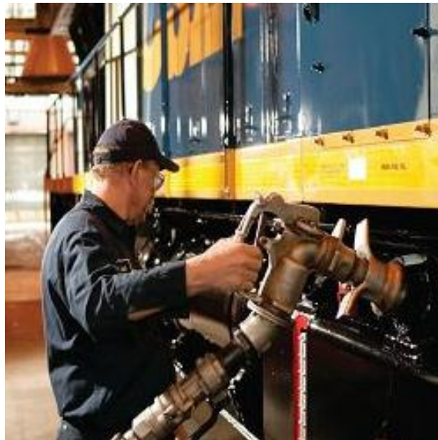
รูปที่ 5-2 การเติมน้ำมันในกรณีรถไฟทางไกลที่มีต้นกำลังเป็นเครื่องยนต์ดีเซล [2]
