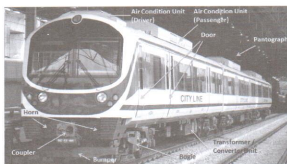
ภาพแสดงส่วนประกอบของขบวนรถไฟฟ้า (1) (ที่มา: ภาพถ่ายของรถไฟฟ้า สาย City Line ในโครงการ Airport Rail Link (SARL))
