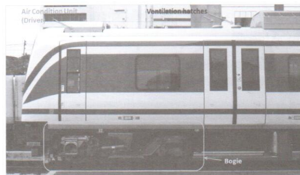
ภาพแสดงส่วนประกอบของขบวนรถไฟฟ้า (2) (ที่มา: ภาพถ่ายของรถไฟฟ้า สาย City Line ในโครงการ Airport Rail Link (SARL))
