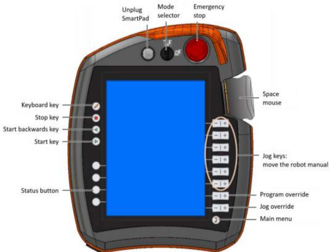
รูปที่ 2 แสดง smart pad KUKA Robot ด้านหน้า
